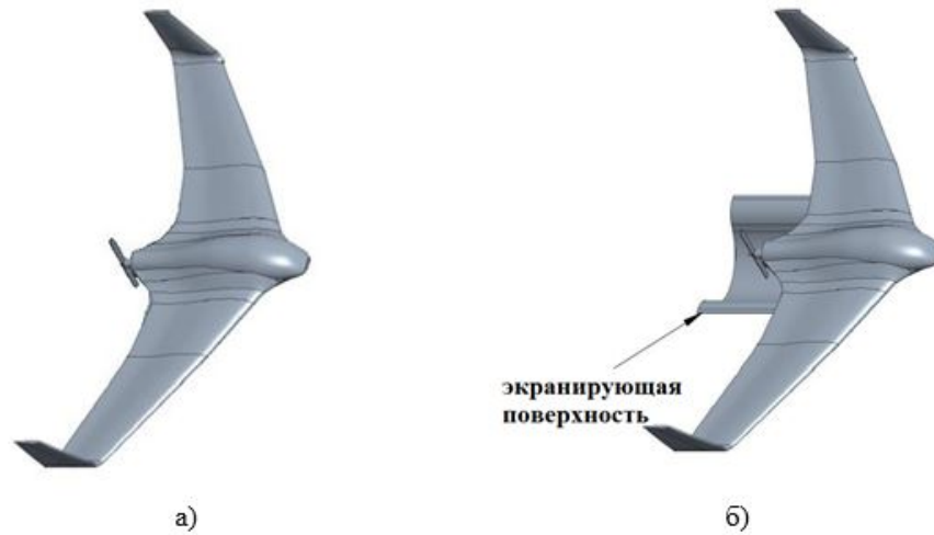
Рис. 1. BVC Skywalker X8 без экранирующей (а) и с экранирующей (б) поверхностями [16]
