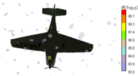
г) частотный диапазон 800–1200 Гц, в составе СУ электродвигатель
