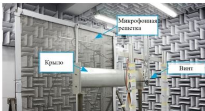
Рис. 4. Схема проведения эксперимента при исследовании экранирования шума воздушного винта крылом [17, 18]
