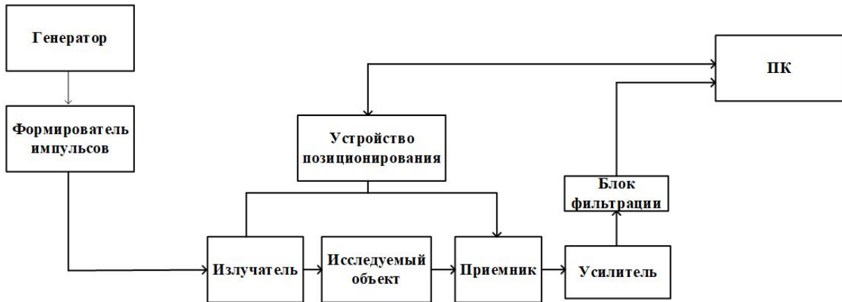
Рис. 2. Структурная схема экспериментальной установки
