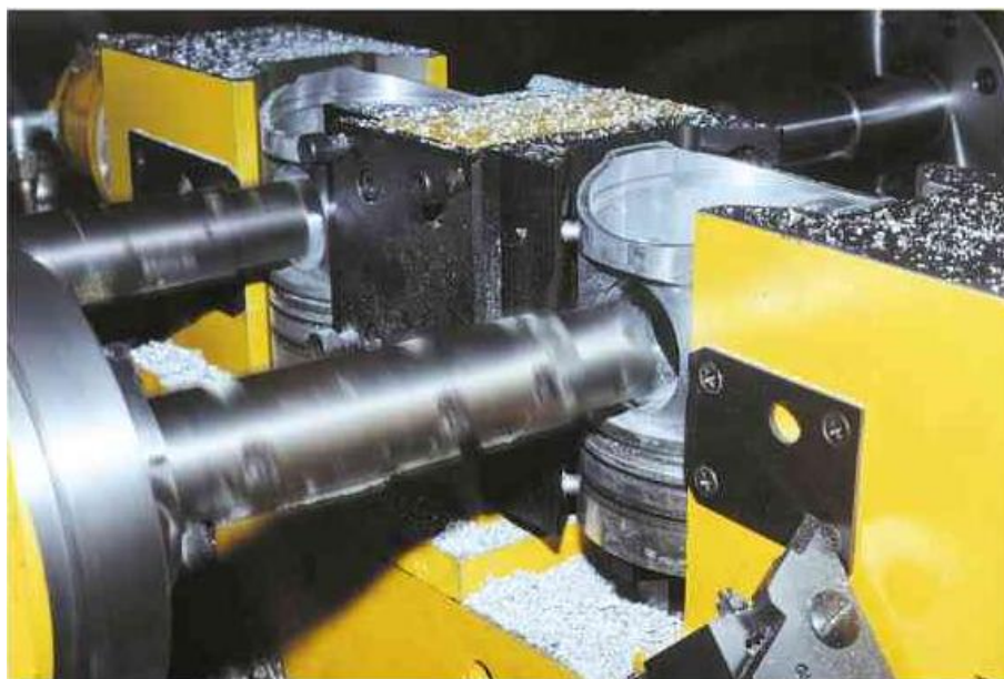
Рисунок 1 – Финишная обработка отверстий с высокой точностью на алмазно-расточных станках
