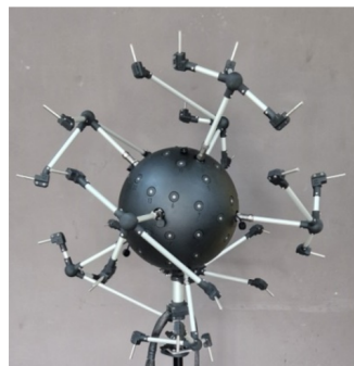
б) расширенная конфигурация, внешний диаметр сферы 80 см, 78 микрофонов. Рабочий частотный диапазон 200-10000 Гц
