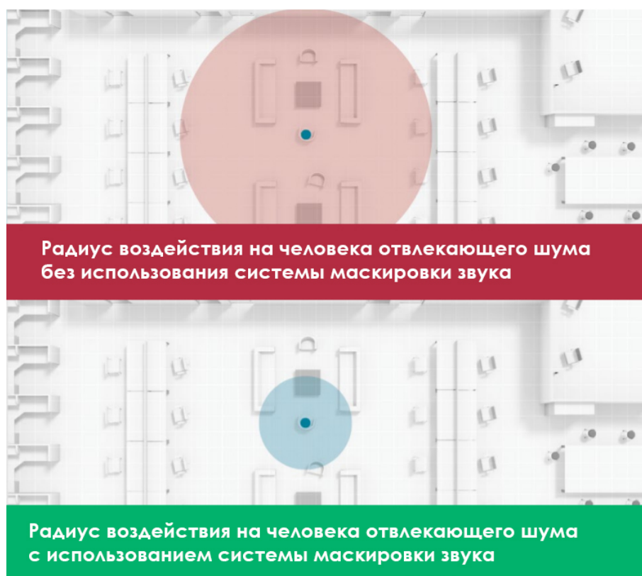
Рисунок 5 – Радиусы воздействия отвлекающего шума на сотрудника офиса без использования и с использованием системы маскировки звука
