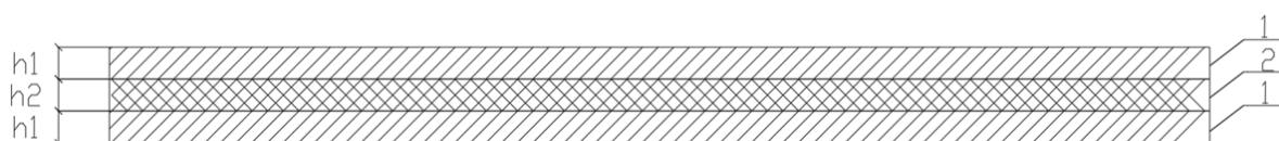
Рисунок 1 – Слоистый материал: 1 – металлическая пластина толщиной 1 мм; 2 – промежуточный слой толщиной (1, 2, 3, 4, 5 мм)
