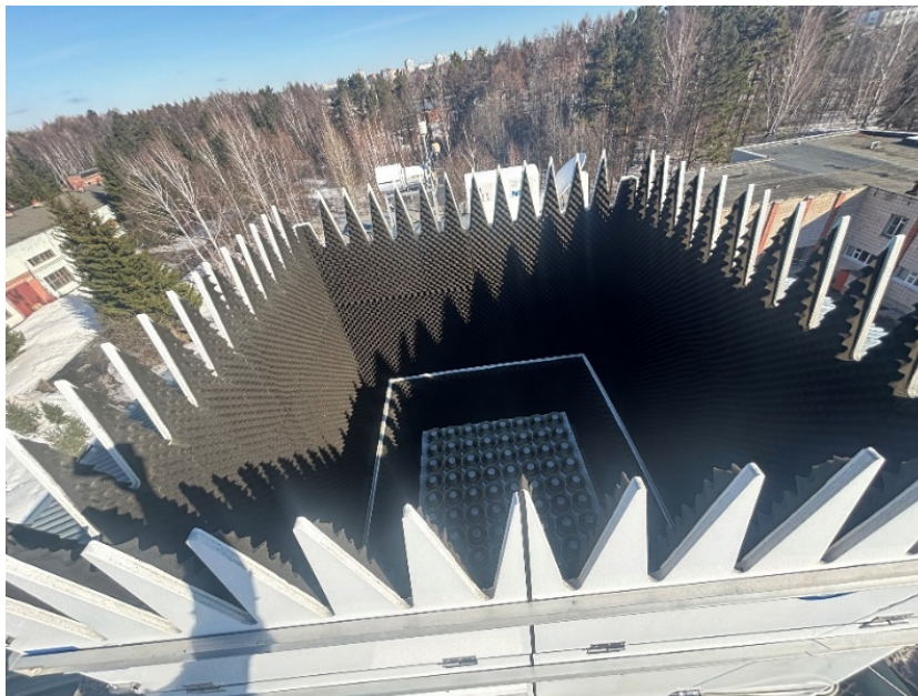
Рисунок 1 – Антенная система содара PCS.2000-64 с антенной решеткой внутри двух звукозащитных бленд
