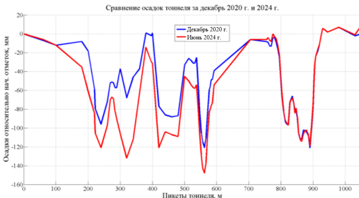
Рисунок 4 – График отклонения деформационных и путевых реперов на рассматриваемом участке в период с декабря 2020г по июнь 2024г
