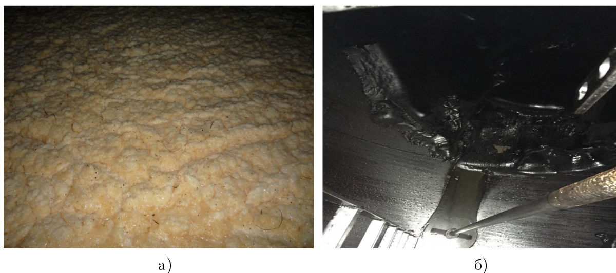
Рис. 1. Твердый остаток н/п в ж/д цистернах в зимний период: а) дизельного топлива, б) высоковязкого мазута марки М100 (вид сверху через смотровой люк ц/с)
